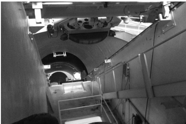
Figure 7 : Les deuxième (en bas de l'image) et troisième (en haut de l'image) miroirs du télescope principal. La salle d'observation se trouve juste en dessous.
